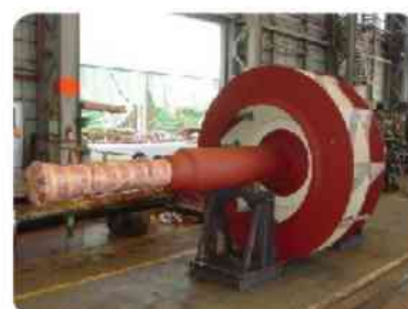
Quạt hút gió lò - Cánh Ceramic (Kiln ID fans ceramic impeller)
