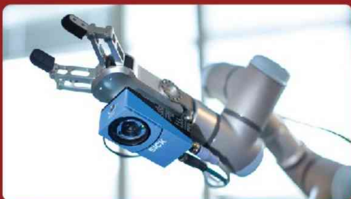
Camera kiểm tra và đo vị trí được tích hợp trên cánh tay robot (Camera vision combine robot arm)
